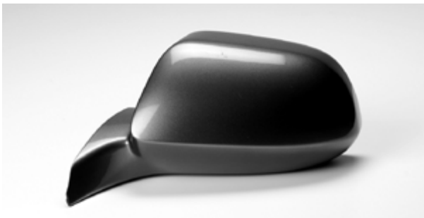
写真2 積層造形品に塗装を行って製作したドアミラー
