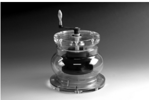
写真3 透明樹脂を磨いて製作した可視化モデル
