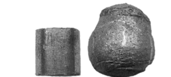
写真3 冷間反復加工なしとありの圧粉体および発泡体
