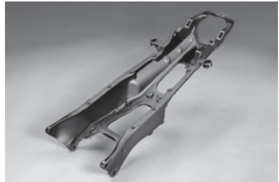
写真4 YZF-R1に採用されているマグネシウムリヤフレーム
