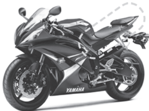
写真2 マグネシウムリヤフレームを搭載した車両
