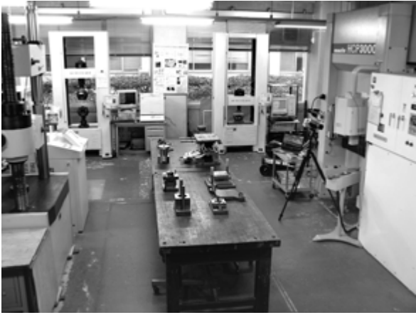
写真1 左より、100tf 油圧サーボ万能試験機、2台の25tf 精密万能試験機、80tf サーボプレス、通電加熱用電源などが設置されている実験室
