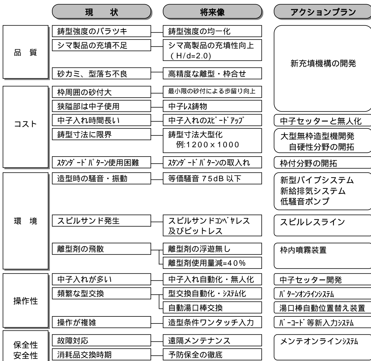
図 3-1. 生型無枠造型機のビジョン
